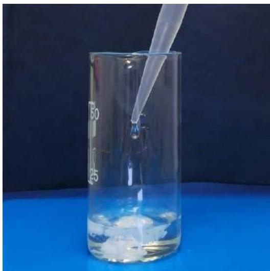
Рисунок 22. Выпадение осадка  $REEPO_4 \cdot nH_2O$  в результате добавления раствора  $NH_4H_2PO_4$  к раствору нитратов РЗЭ
