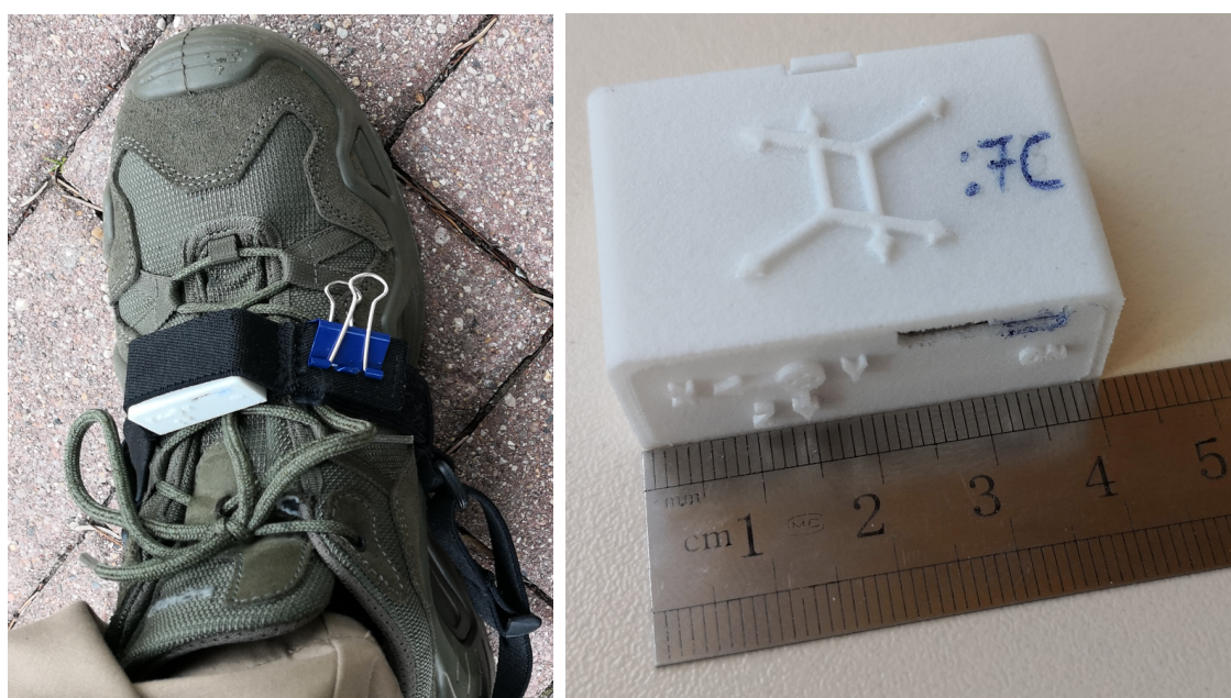
Рис. 3.5: Слева – способ крепления ИИБ на стопы в первой серии экспериментов. Справа – сам ИИБ.
