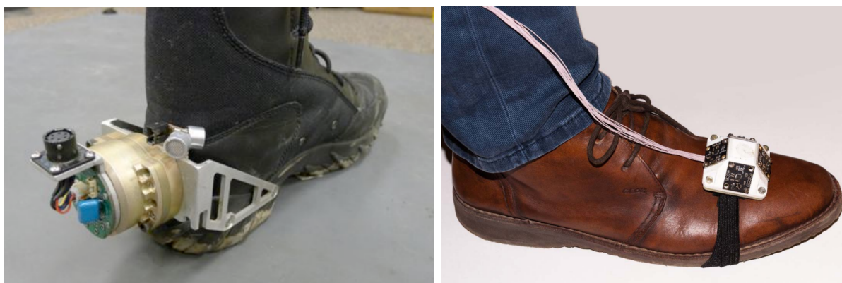
Рис. 1.2: Примеры крепления ИИБ. Слева крепление на жесткий кронштейн к пятке, справа – на эластичную ленту на подъем стопы
