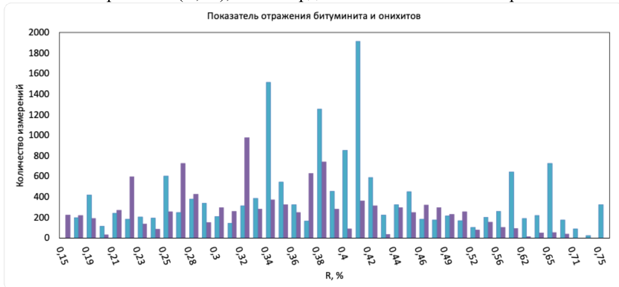
Рисунок 12 – Распределение значений показателя отражения онихитов ( R_{onh} , %) (голубые столбцы) и битуминита ( R_V , %) (фиолетовые столбцы) по совокупности индивидуальных измерений
