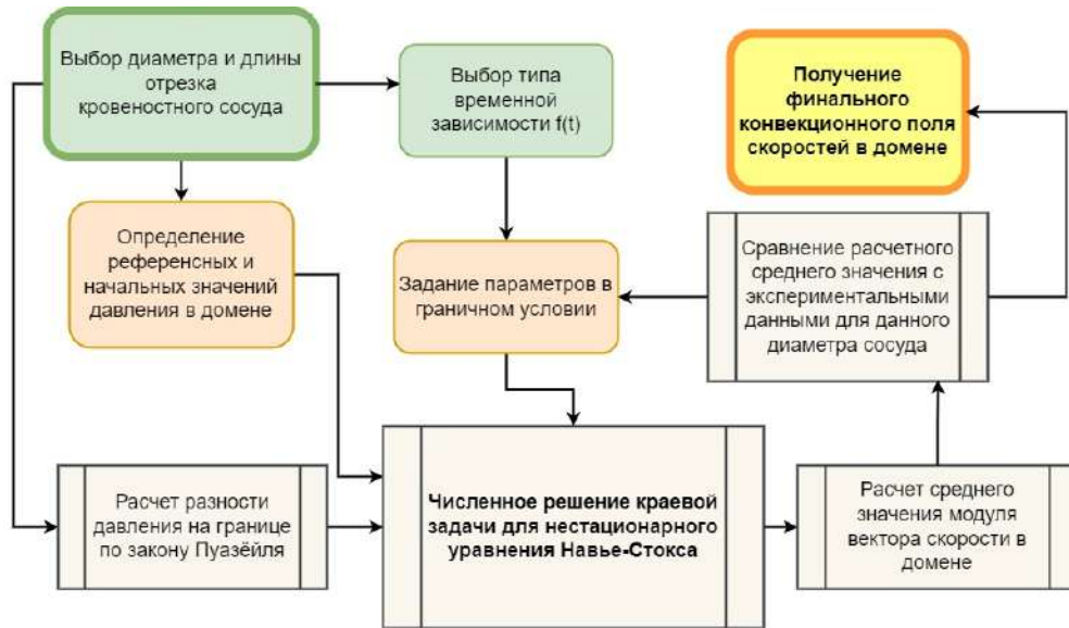
Рисунок 13 – Алгоритм валидации параметров граничных условий для краевой задачи уравнения Навье-Стокса в случае моделирования конвекции в цифровом домене, соответствующему люмену отрезка кровеносного сосуда
