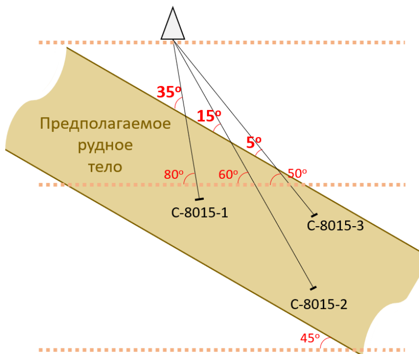
Рисунок 23 – Изображение разреза с указанием трех скважин, имеющих СВ направление (азимут 115°), с углами от поверхности 80°, 60° и 50°: 8015-1, 8015-2 и 8015-3, соответственно
