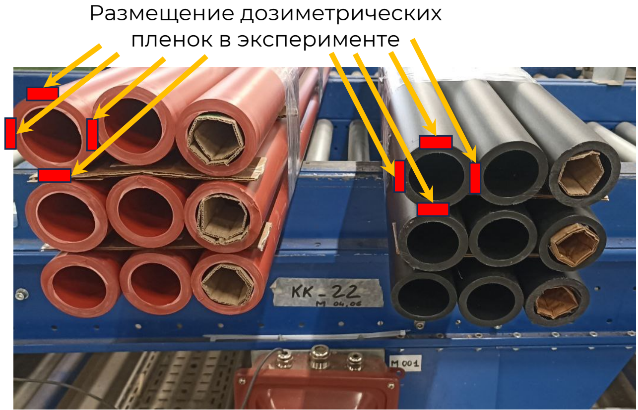
Рисунок 2.9 – Размещение дозиметрических пленок в эксперименте с облучением термоусаживающихся трубок V1(к) 36/55×9-1400 (слева) и V1(4) 45/59×7-1400 (справа).
