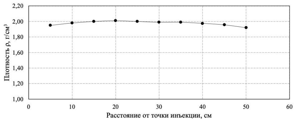
Рис. 41. Изменение плотности песка ( K_{ik} ) по длине инъекционной колонны, закрепленного кремнеземисто-эпоксидным вяжущим
