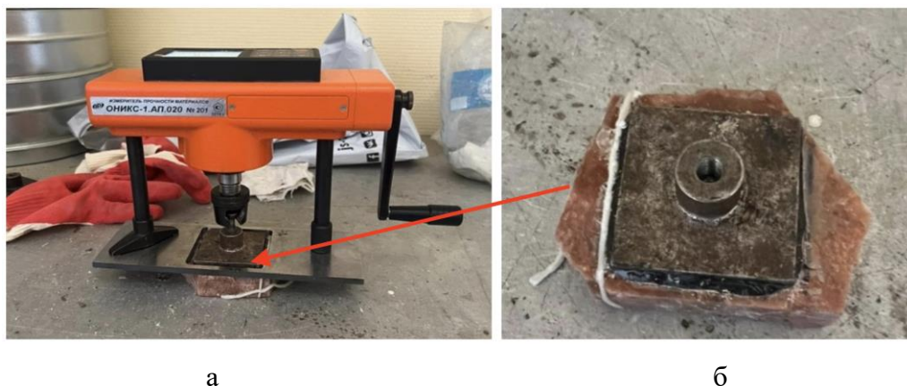
Рис. 35. Адгезиметр ОНИКС-1 АП (а) для определения прочности сцепления модифицированного раствора алифатической эпоксидной смолы с поверхностью калиевого полевого шпата (б)
