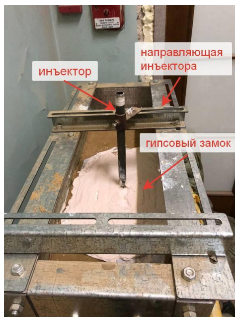
Рис. 105. Стендовая установка для физического моделирования инъекционного закрепления методом пропитки (вид сверху)
