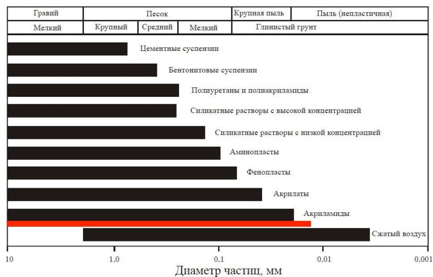
Рис. 2. Предел применимости различных инъекционных растворов (черный цвет) [146] и область применения кремнеземисто-эпоксидного состава (красный цвет)
