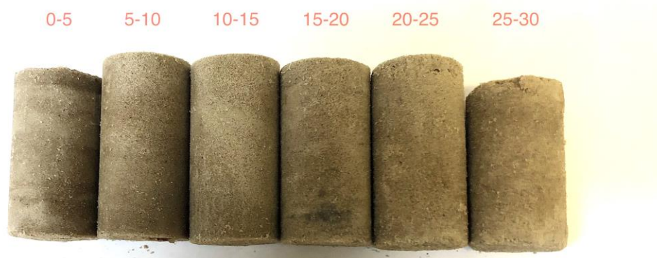
Рис. 55. Внешний вид закрепленных песков ( aQ_{III}^{II} ), хранившихся в воздушно-влажных условиях, после испытаний на одноосное сжатие; красным цветом – интервалы опробования по длине инъекционной колонны (см)
