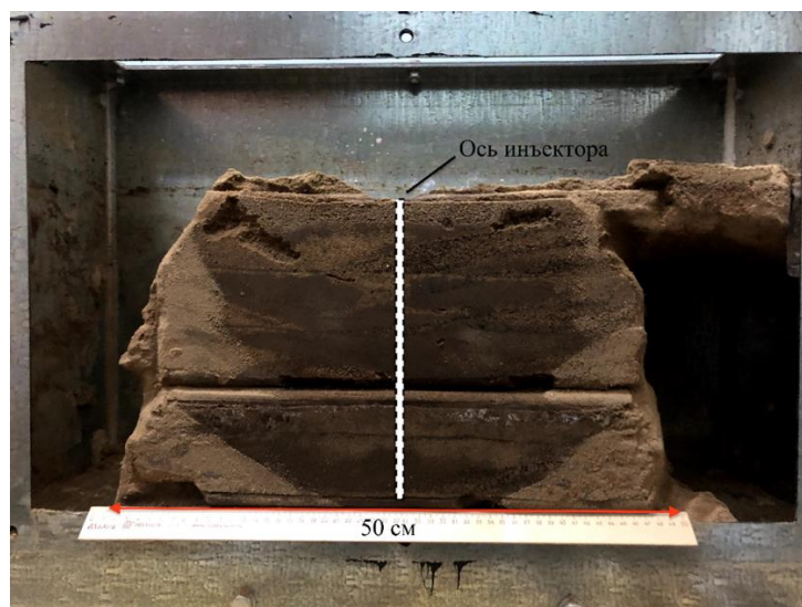
Рис. 106. Закрепленный методом пропитки в стендовой установке целик песчаного грунта ( aQ_{III}^{II} ) (вид с фронтальной части)
