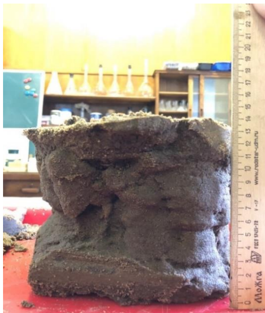
Рис. 76. Внешний вид закрепленного целика песчаного грунта после инъекционной пропитки, насыщенного концентрированным рассолом хлорида натрия
