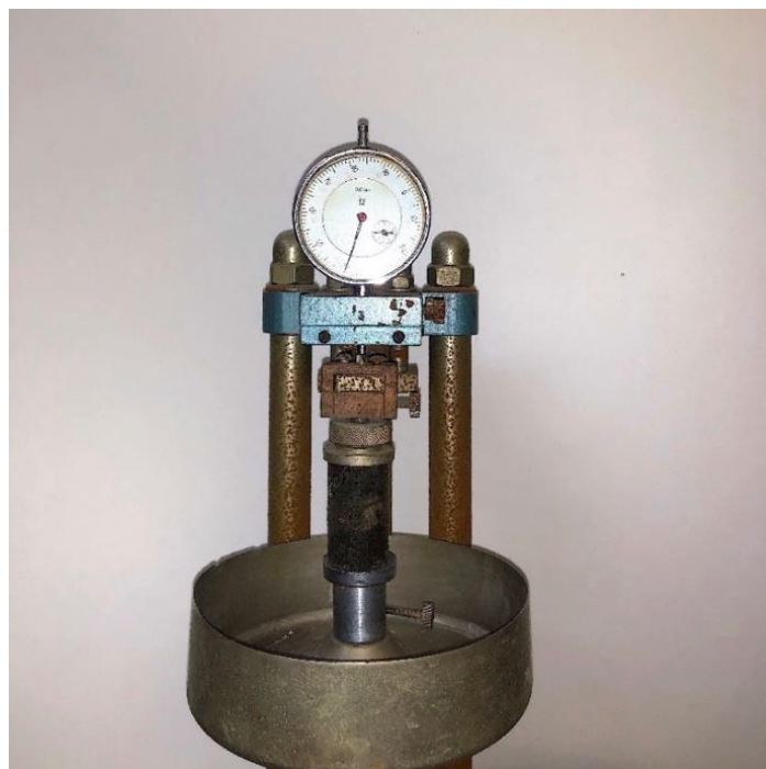
Рис. 24. Образец закрепленного песчаного грунта в приборе для испытаний на одноосное сжатие МП-2С; высота образца – 50 мм, диаметр – 25 мм
