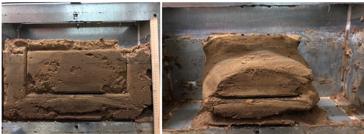
Рис. 114. Внешний вид закрепленного в водонасыщенных условиях целика грунта; а – после вскрытия модели, б – после удаления незакрепленного грунта
