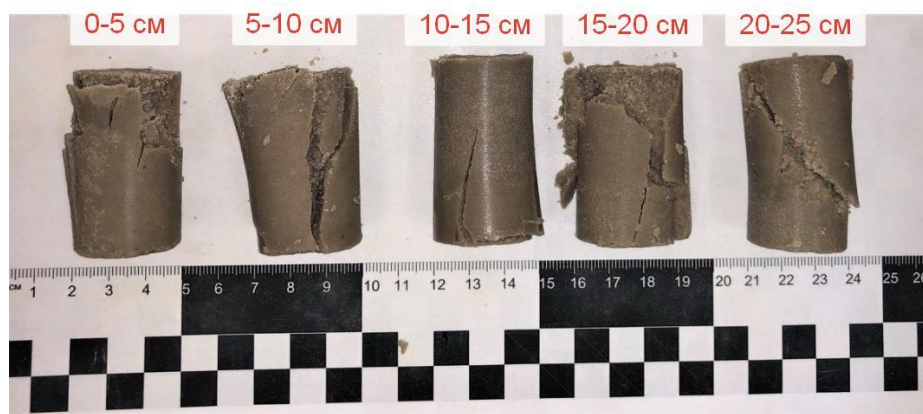
Рис. 48. Внешний вид закрепленных песков ( K_{ik} ), хранившихся в воздушно-влажных условиях, после испытаний на одноосное сжатие; красным цветом – интервалы опробования по длине инъекционной колонны
