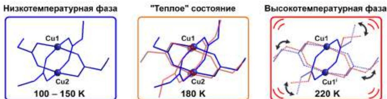
**Рисунок 4.54.** Тепловое разупорядочение димера [(Cu1Cu2)Prop<sub>4</sub>] в кристаллической структуре VIII-K при различных температурах. Разупорядоченные позиции с большей заселенностью изображены синим цветом.
