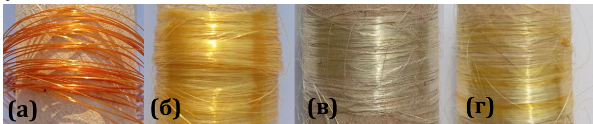
Рисунок 17. Фотографии волокон В1 (а), В2 (б), В3 (в) и В4 (г), полученных из расплавов сополимеров АН и ВИМ. Подробное описание образцов дано в тексте.
