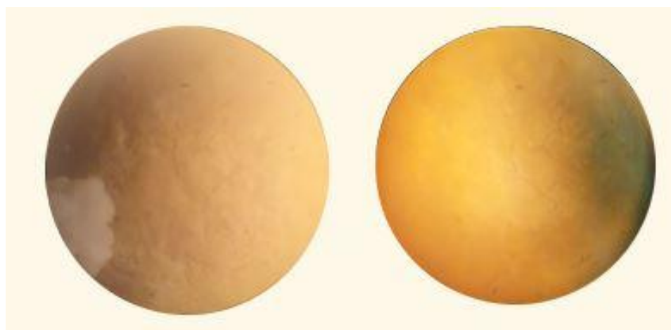
Рисунок 49. Оболочки удобрения Osmocote после проведения опыта (через 21 сутки) при увеличении в 100 раз.
