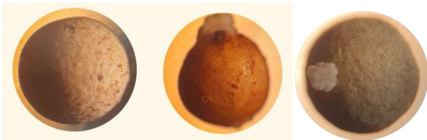
Рисунок 48. Оболочки удобрения Osmocote после проведения опыта (через 21 сутки) при увеличении в 40 раз.
