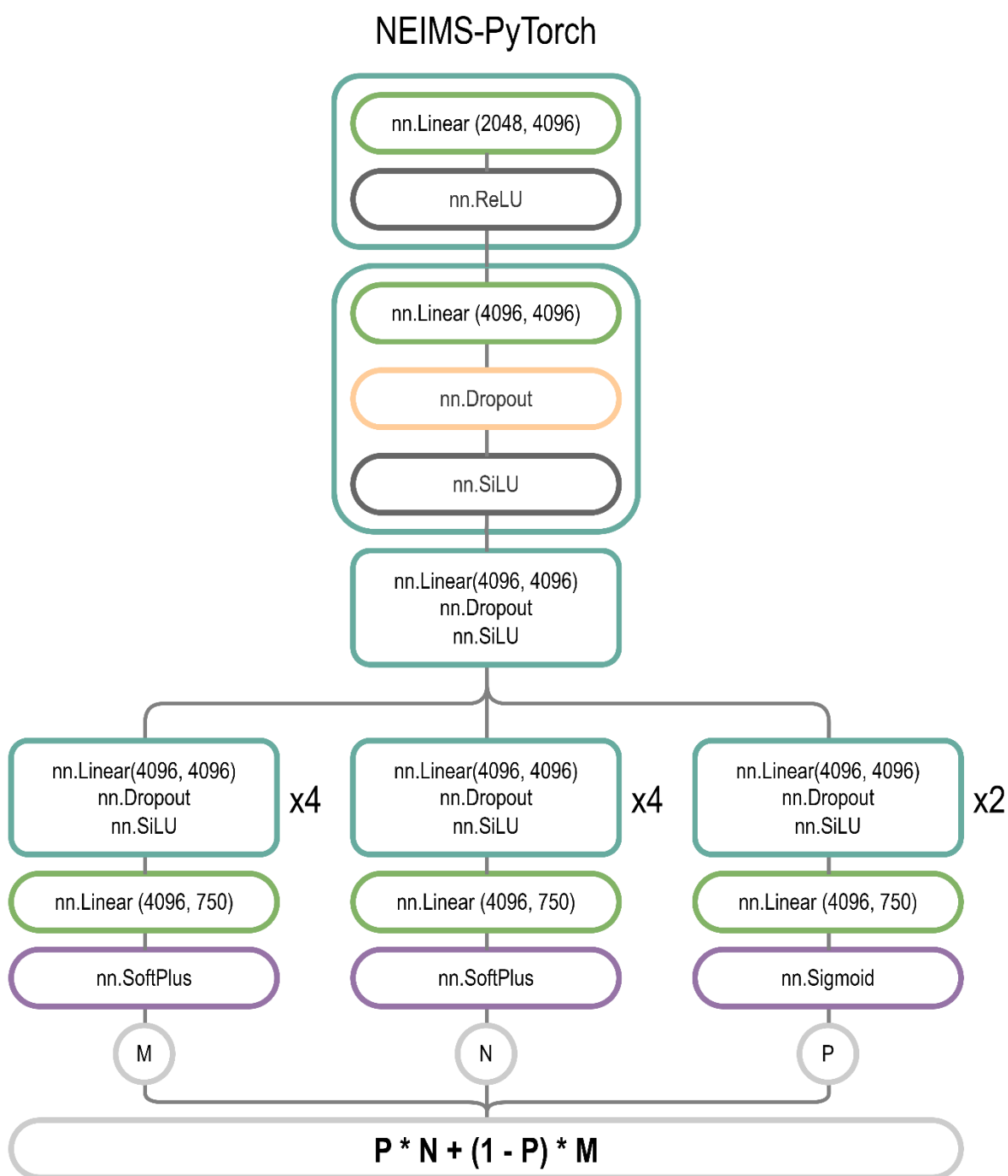
Рисунок 7. Архитектура нейросетевой модели NEIMS-PyTorch для предсказания масс-спектров электронной ионизации. Ветка M предсказывает нормальные масс-спектры, ветка N – нейтральные потери, P – соотношение между M и N (значения от 0 до 1).
