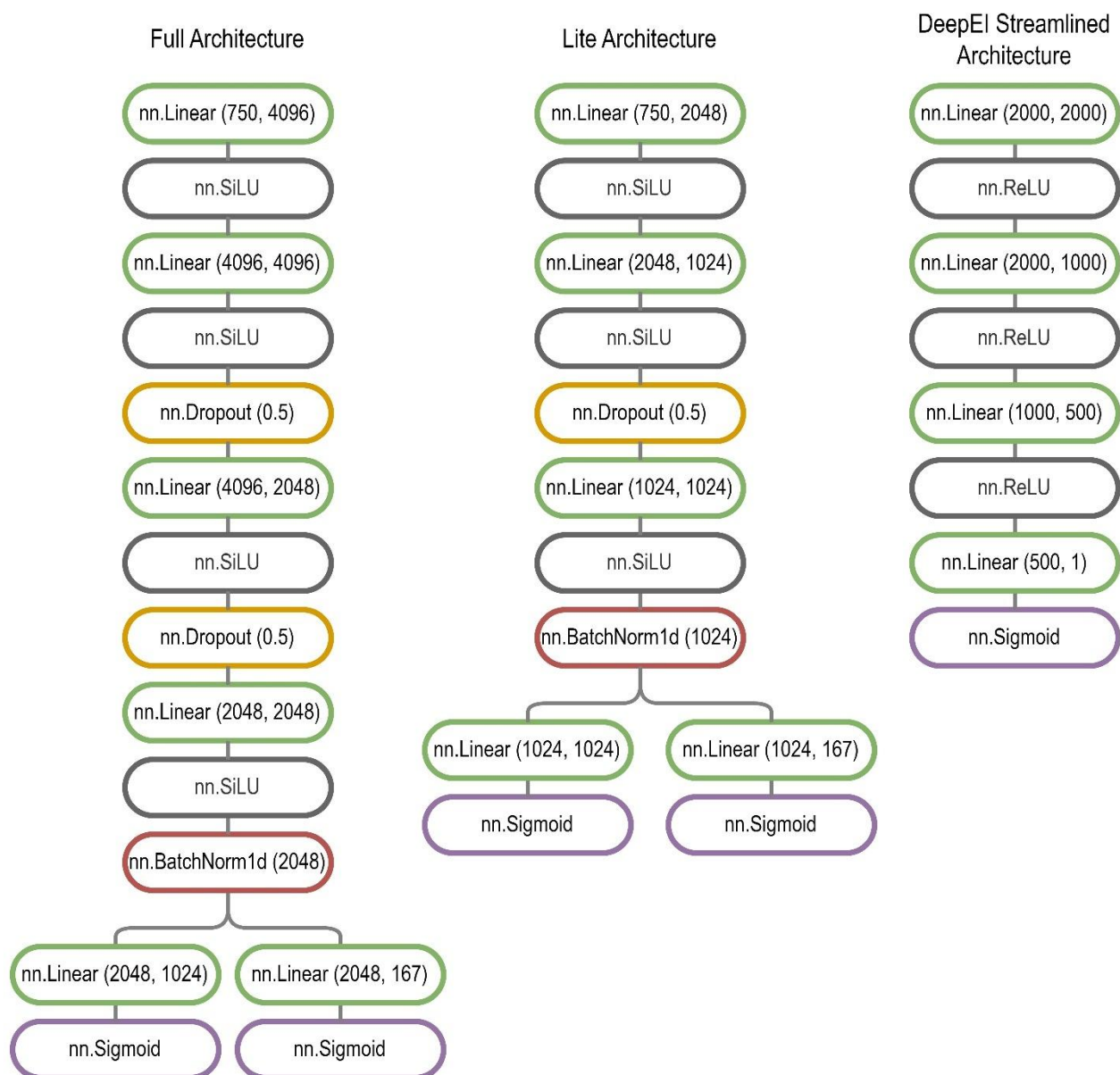
Рисунок 8. Архитектуры нейросетевых моделей для предсказания молекулярных отпечатков пальцев по масс-спектрам электронной ионизации.
