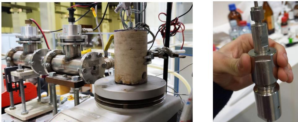
Рисунок 70. Установка для исследований системы методом in situ XAS.
