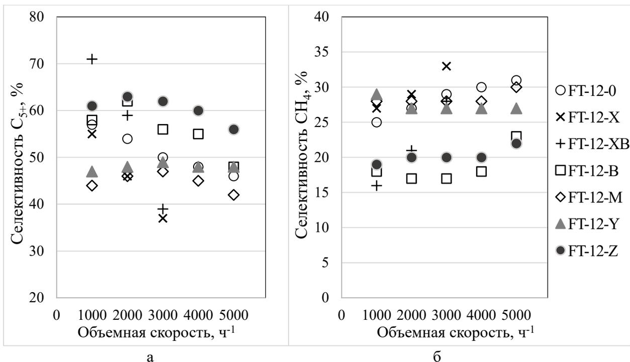
Рис. 3.20. Зависимость селективности образования углеводородов С<sub>5+</sub> (а) и метана (б) от объемной скорости
