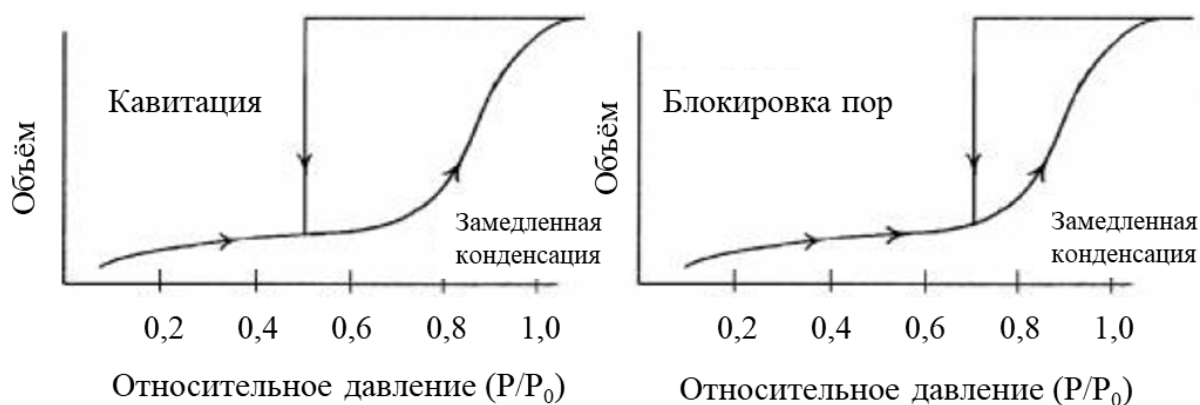
Рисунок 3.12. Схематическая иллюстрация эффектов кавитации и блокировки пор [123]
