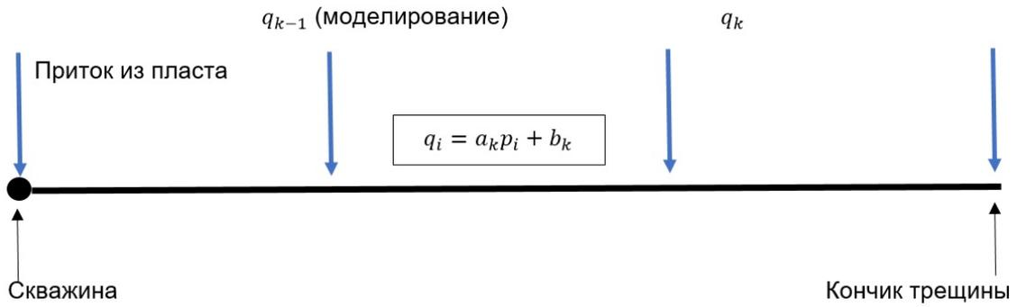
Рисунок 6.11: Схема численного моделирования в системе трещина-пласт.
