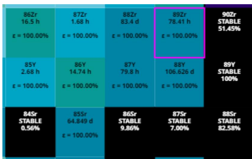
Рис. 4: Расположение изотопа ^{89}\text{Zr} на карте атомных ядер среди стабильных изотопов стронция и иттрия, из которых он может быть получен в реакциях под действием тяжелых заряженных частиц.
