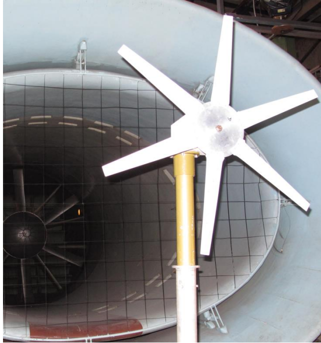
Рис. 4.9. Ветроэнергетическая установка в дозвуковой аэродинамической трубе
