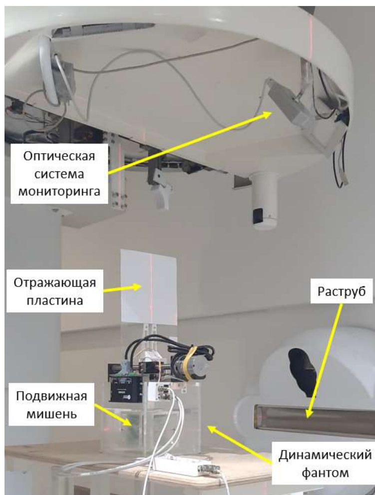
Рисунок 3.9 – Процесс облучения динамического фантома и мониторинга движения его мишени с помощью оптической системы.
