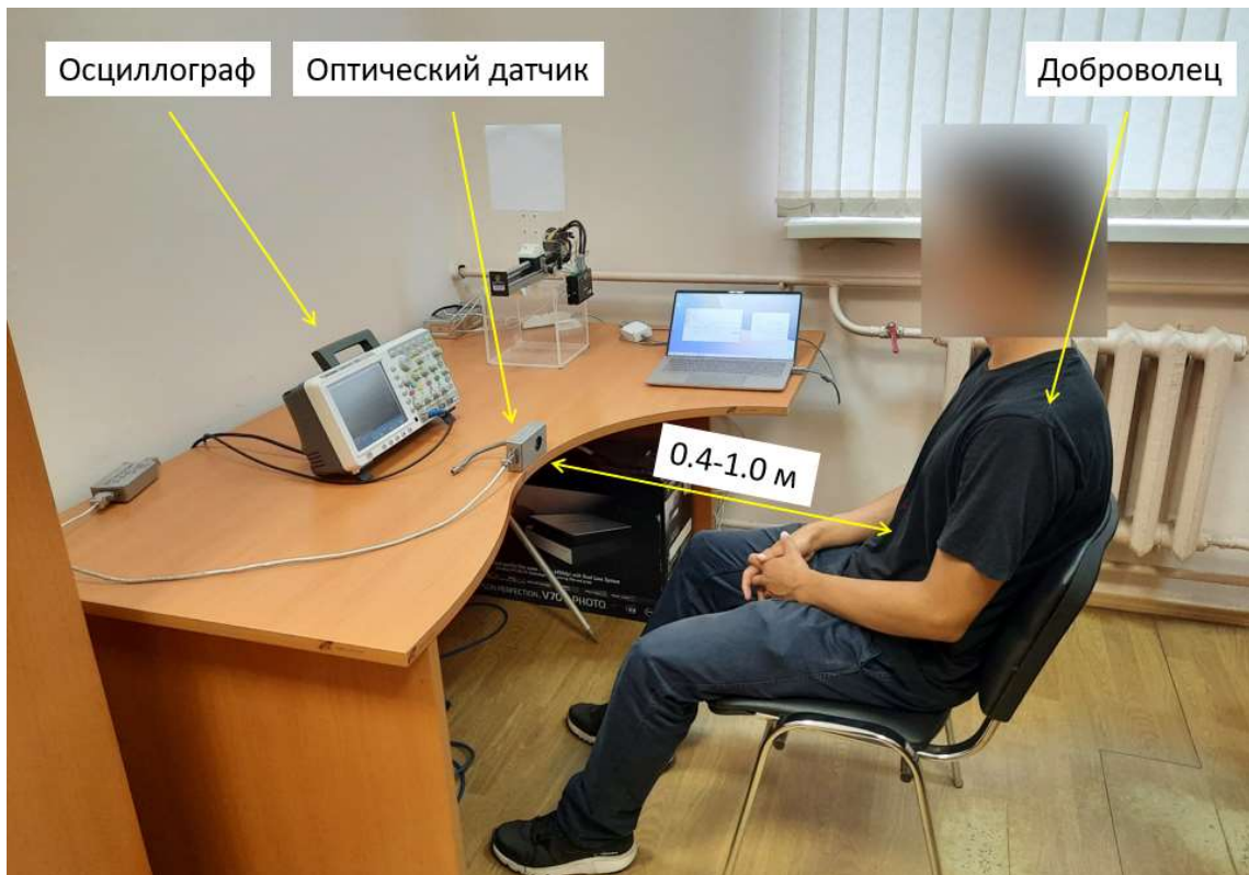
Рисунок 3.19 – Процесс мониторинга дыхания добровольца с помощью оптической системы
