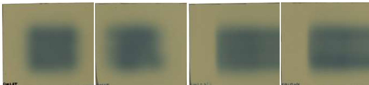
Рисунок 2.13 – Отсканированные облученные радиохромные пленки
