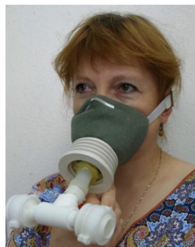
Рис. 15. Устройство, используемое для сбора выдыхаемых МЛЖ на нейлоновых фильтрах. (А) Конструкция держателя фильтра, изготовленного на 3D-принтере. (Б) Собранный прибор, состоящий из коммерческого респиратора и двух фильтров. (В) Сбор образца добровольцем.
