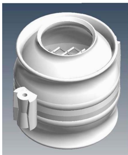
Рис. 15. Устройство, используемое для сбора выдыхаемых МЛЖ на нейлоновых фильтрах. (А) Конструкция держателя фильтра, изготовленного на 3D-принтере. (Б) Собранный прибор, состоящий из коммерческого респиратора и двух фильтров. (В) Сбор образца добровольцем.
