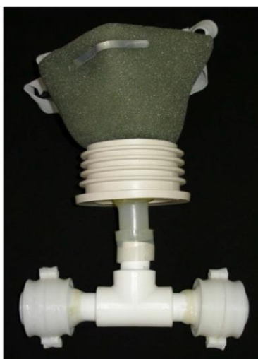
Рис. 15. Устройство, используемое для сбора выдыхаемых МЛЖ на нейлоновых фильтрах. (А) Конструкция держателя фильтра, изготовленного на 3D-принтере. (Б) Собранный прибор, состоящий из коммерческого респиратора и двух фильтров. (В) Сбор образца добровольцем.
