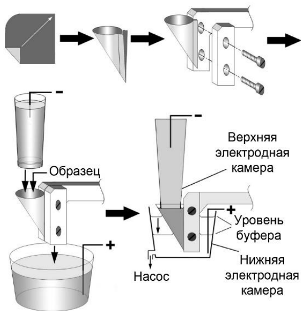
Рис. 79. Конструкция устройства для концентрирования биомакромолекул. Коническая ячейка формируется из листа диализной мембраны, зажимается в держателе и помещается в камеру для электрофореза. В ячейку загружают образец, включают напряжение и откачивают раствор из нижней камеры с помощью насоса.
