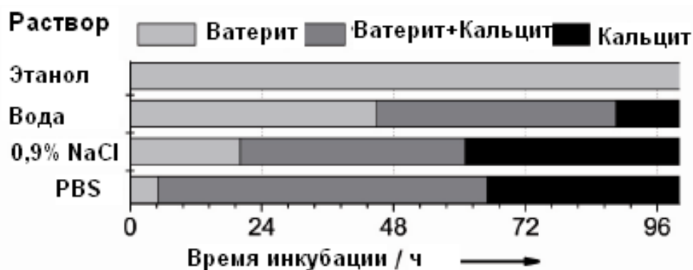
Рис. 1.6. Влияние среды и времени на перекристаллизацию ватерита. Адаптировано из [94].
