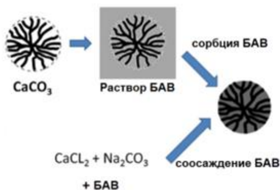
Рис. 1.7. Основные способы включения БАВ в микросферы ватерита. Адаптировано из [41].
