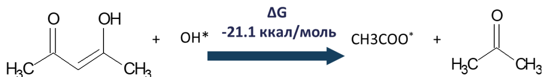
Рис.45 Реакция образования уксусной кислоты при радиолизе ацетилацетона
