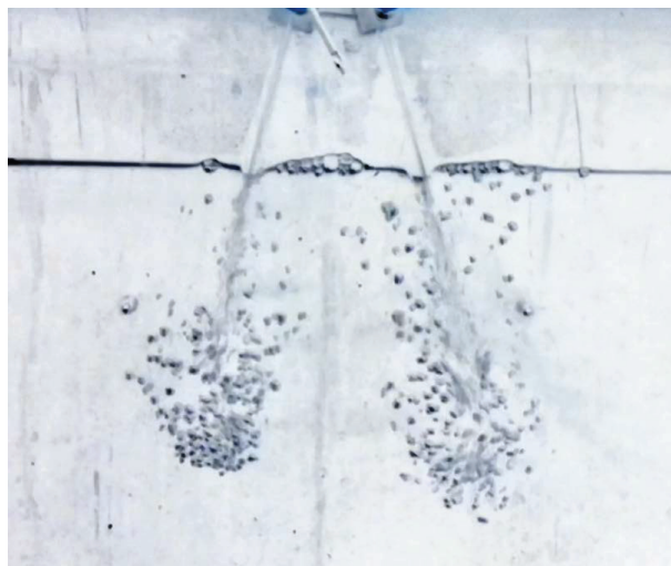
Рис. 3-2. Фотоснимок течения при H = 10 см, \alpha = 30^\circ , Fr = 4 .
