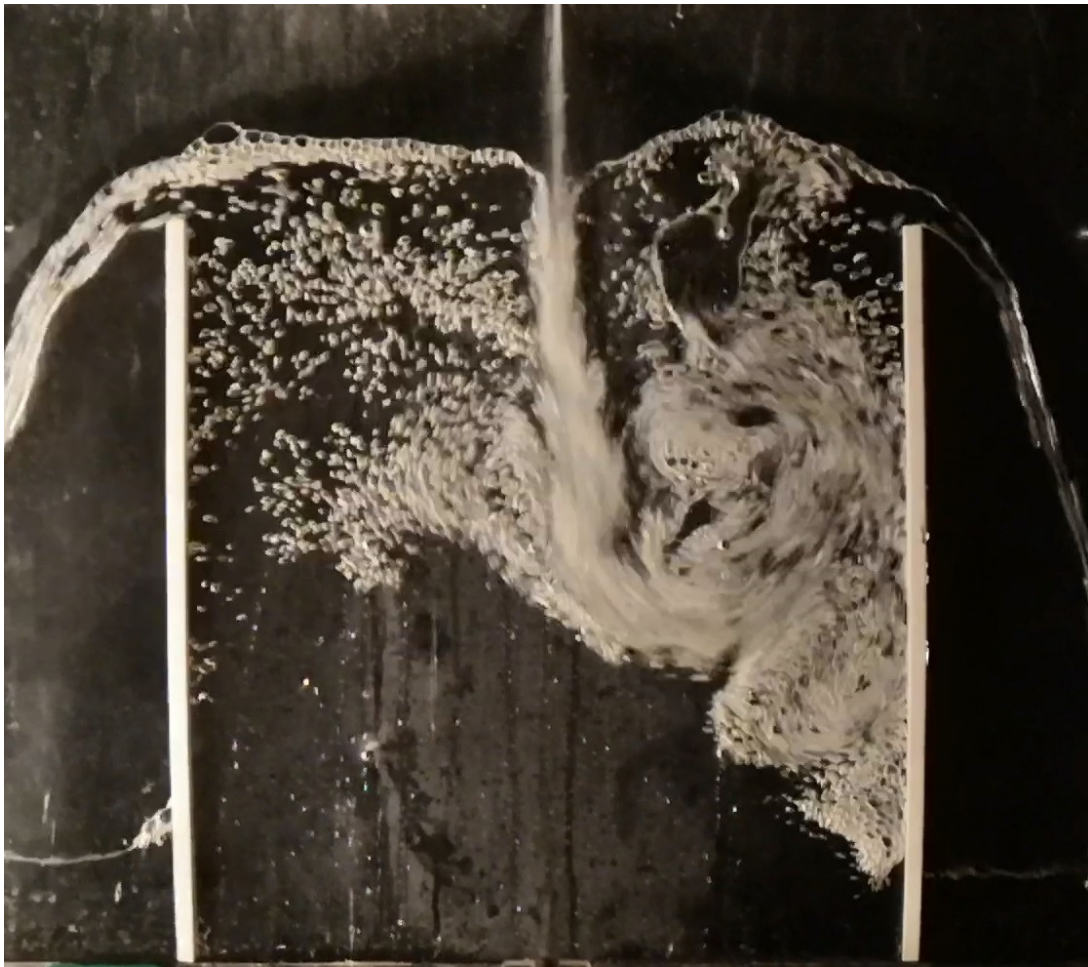
Рис. 1.11. Режим с циркуляционной зоной. Fr = 16, L/h = 40, \delta/h = 0.5
