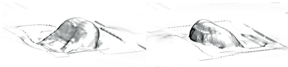
Рис. 2.15. Крайние положения колеблющегося фонтана для случая L = 5 см, H = 2 см и V = 1 м/с.
