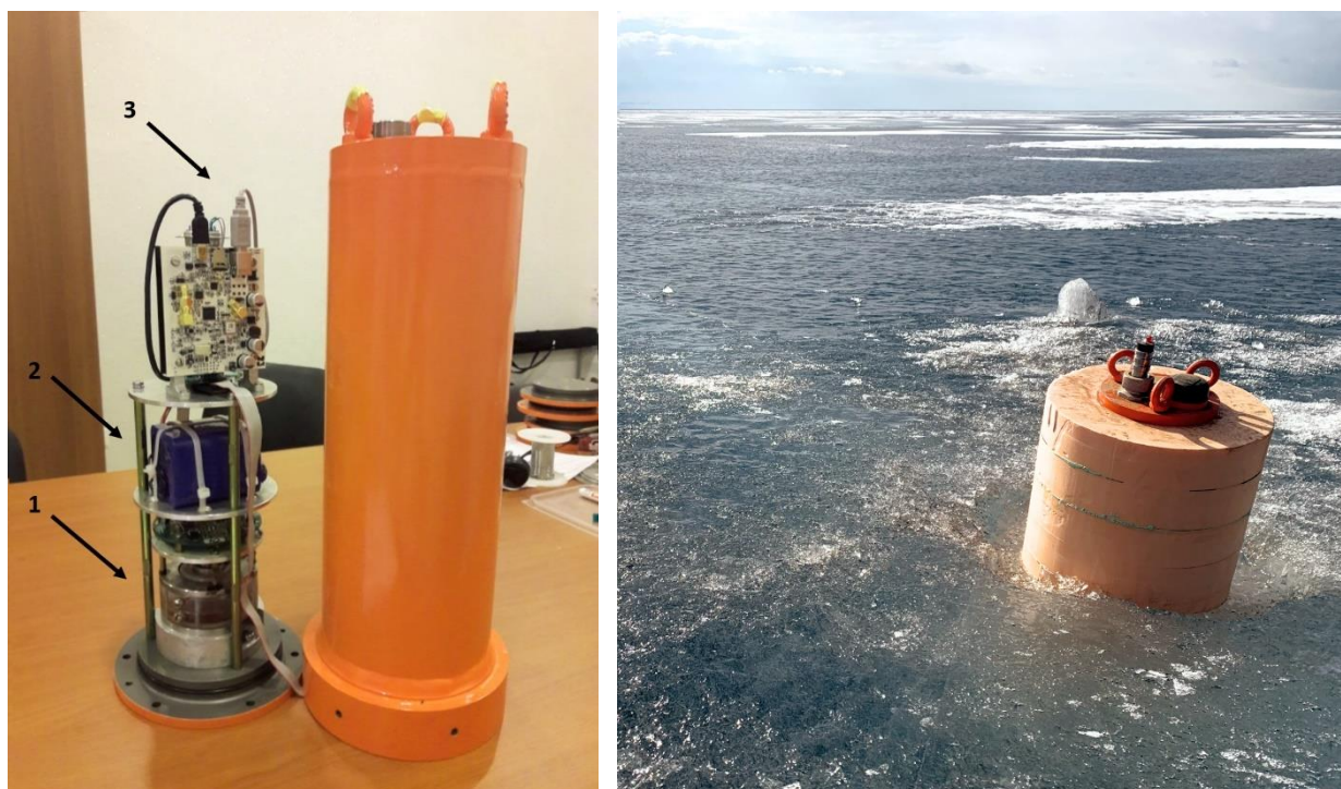
Рис. 4.3. Макет вмораживаемого геоакустического информационно-измерительного буя: 1 – воспринимающие сенсоры; 2 – элементы питания; 3 – цифровой регистратор и блок электроники (слева). Справа – рабочий макет вмораживаемого буя на льду озера Байкал.
