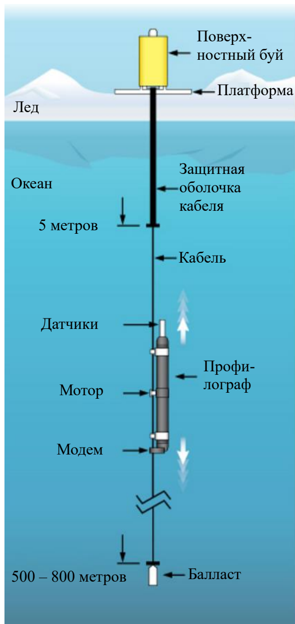
Рис. 4.2. Конструкция вмораживаемого профилографа [237, 272].
