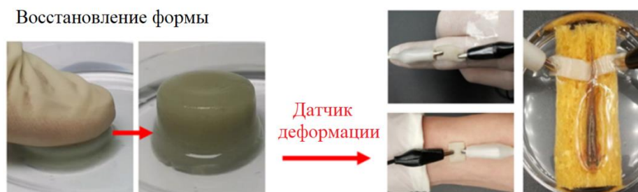
Рис. 1.18 Иллюстрация применения гидрогеля для создания самовосстанавливающегося после механической нагрузки скаффолда, который может быть использован как датчик движения [113].
