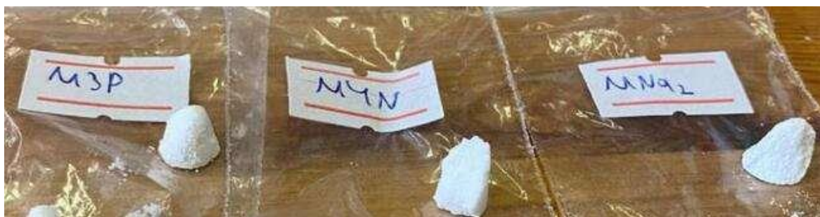
Рис. 3.48 Фото образцов керамики после механических испытаний.
