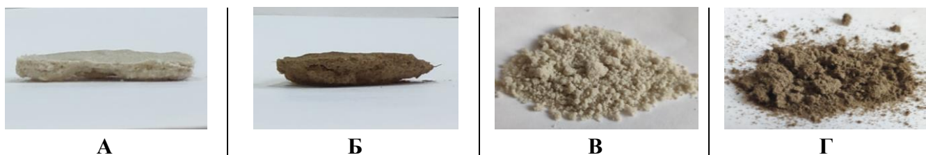
Рисунок 18. Композиционные материалы, полученные на основе песка (А, В) или почвы (Б, Г) и макрогелей АГГ#1 (А, Б), АГГ#6 (В, Г).
