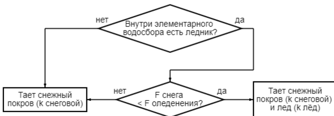
Рисунок 2.6 – Блок-схема работы ледникового блока ( k_{\text{снег}} – коэффициент таяния снега, k_{\text{лед}} – коэффициент таяния льда)
