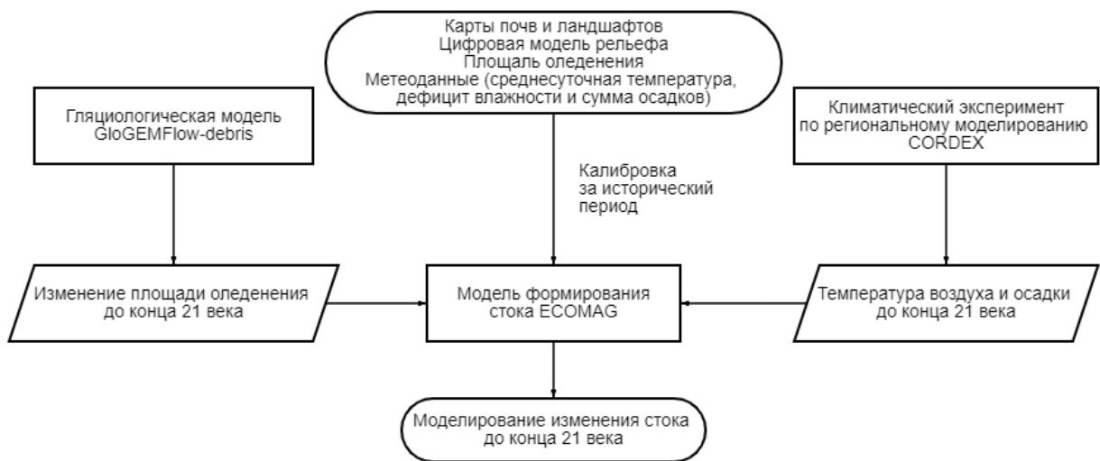
Рисунок 5.5 – Схема усвоения данных климатического и гляциологического моделирования моделью формирования стока ECOMAG [Корнилова и др., 2023]
