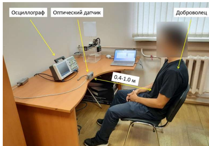
Рисунок 3 – Процесс мониторинга дыхания добровольца с помощью оптической системы
