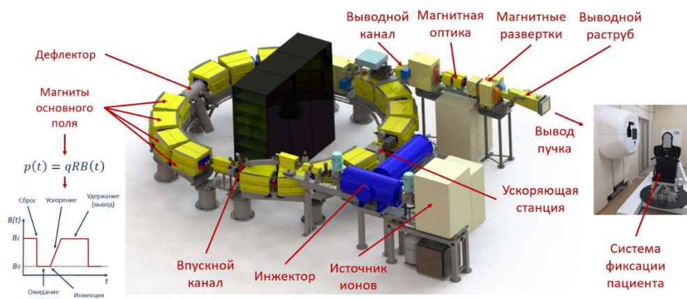
Рисунок 7 – Внешний вид протонного синхротрона комплекса протонной терапии «Прометеус» с указанием основных функциональных элементов
