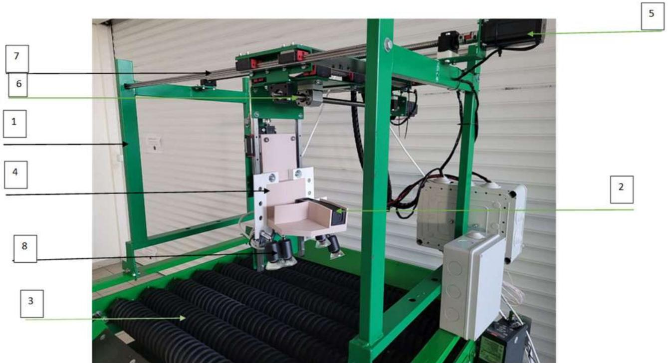
Рисунок 20 — Стенд для гиперспектральной съёмки яблок. Обозначения: 1) транспортное сортировочное устройство, 2) гиперспектральная камера, 3) стол с резиновыми роликами, 4) подвес камеры, 5) шаговые электродвигатели, 6) направляющие, 7) реечные передачи, 8) источник света. По [265].
