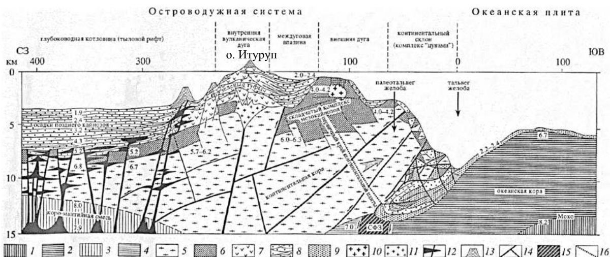
Рисунок 3.1.1. Геологический разрез через переходную зону на широте о. Итуруп (Ермаков, 1997). 1 – океанская мантия; 2 – океанская кора; 3 – преобразованная (океанизированная) континентальная кора; 4 – базальтовый слой континентальной коры; 5 – гранитный слой; 6 – складчатый комплекс позднего мела-палеогена; 7 – формация «зеленых туфов»; 8 – позднекайнозойские осадочные породы впадины; 9 – осадки океанского дна; 10 – интрузии складчатого комплекса; 11 – интрузии – комагматы зеленых туфов; 12 – подводные каналы вулканов, силлы; 13 – вулканы; 14 – разломы; 15 – сейсмофокальная зона; 16 – первичный край континентальной коры. Цифры на разрезе – скорости продольных сейсмических волн в км/с. Превышение горизонтального м-ба над вертикальным в 10 раз
