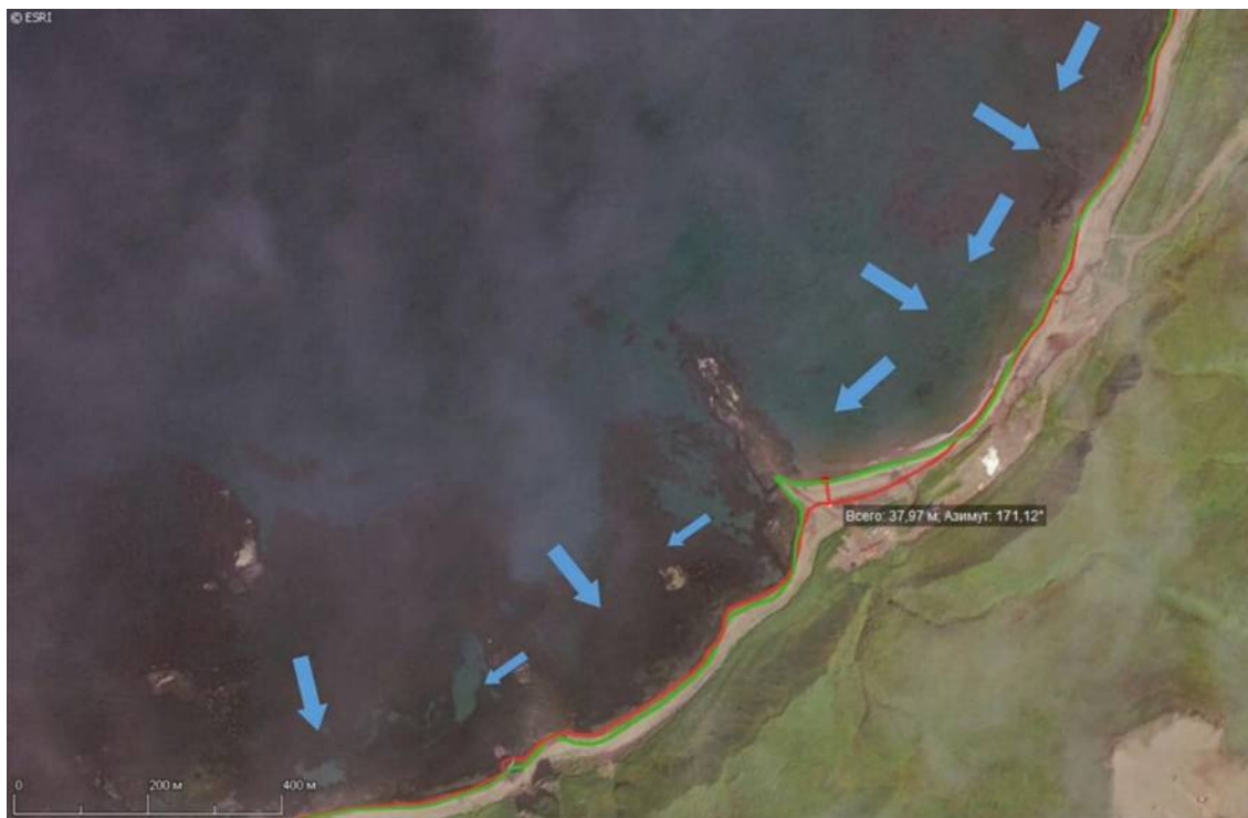
Рисунок 4.1.34. Динамика берега у посёлка золотодобытчиков «КурилГЕО». Красным цветом изображена береговая линия на начало освоения (2012 год). Зелёным цветом – данные GPS-приёмника автора на 09.2019 (источник: Google Earth)
