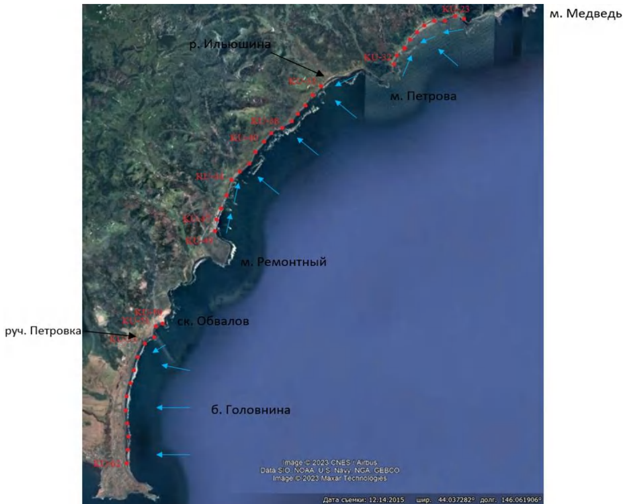
Рисунок 4.1.27. Направление перемещения наносов в береговой зоне на участке Южно-Курильск – мыс Медведь (источник: Google Earth)
