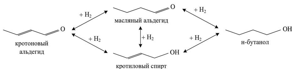
**Рисунок 9.** Схема гидрирования кротонового альдегида [46]
