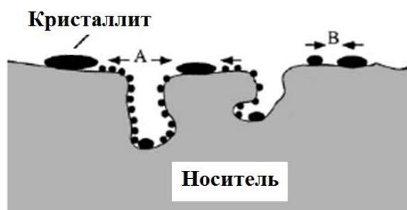
**Рисунок 20.** Спекание частиц путем (А) атомной миграции и (В) миграции кристаллитов [82]
