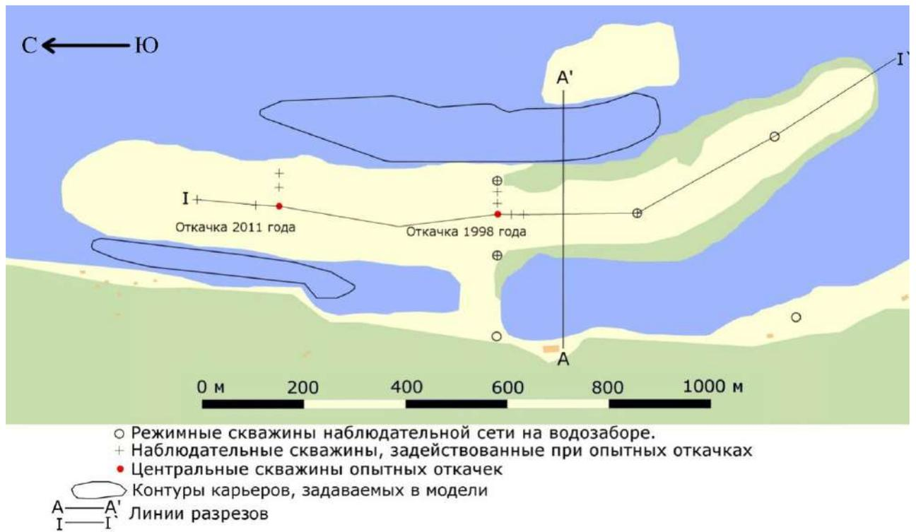
Рисунок 4.6. Схема искусственного острова и расположение опытных скважин.
