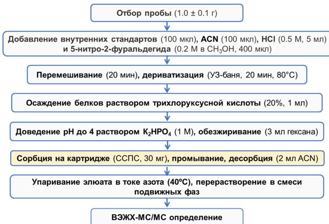
**Рис. 25.** Схема пробоподготовки куриного мяса и субпродуктов с 5-нитро-2-фураляльдегидом и сверхсшитым полистиролом перед ВЭЖХ-МС/МС определением в них метаболитов нитрофуранов.
