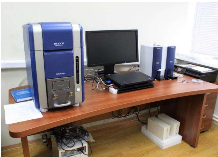
*Рисунок 11. Сканирующий электронный микроскоп HitachiTM3000 (слева) и рентгеноспектральный анализатор SwiftED3000 (Oxford)*
