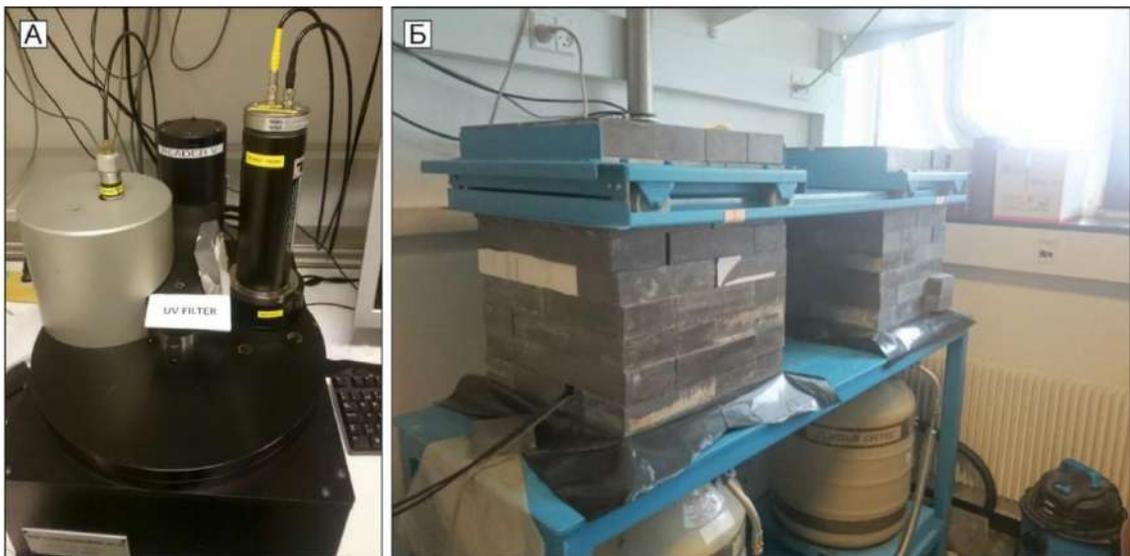
Рисунок 15. Оборудование для проведения ОСЛ-датирования: А – ТЛ/ОСЛ-ридер Riso, модель DA-20; Б – Гамма-спектрометры в свинцовой защите для измерения естественной радиации отложений
