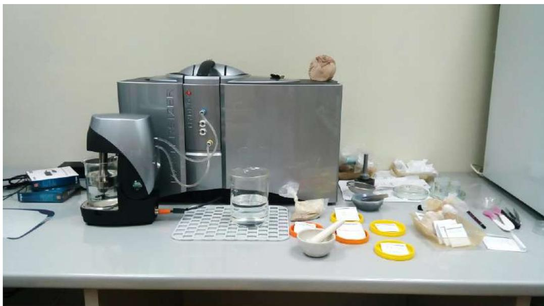
*Рисунок 9. Лазерный гранулометр Mastersizer 3000 (Malvern) с диспергатором в водной среде*
