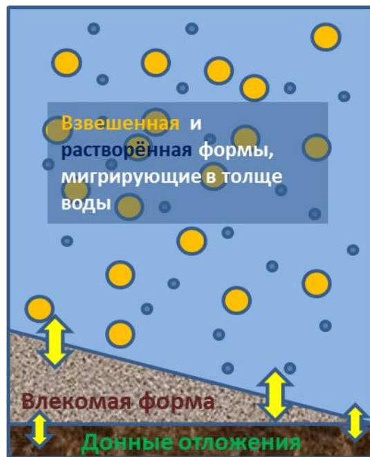
**Рисунок 1.7 Схема взаимодействия компонентов в системе «вода-наносы-донные отложения»**
