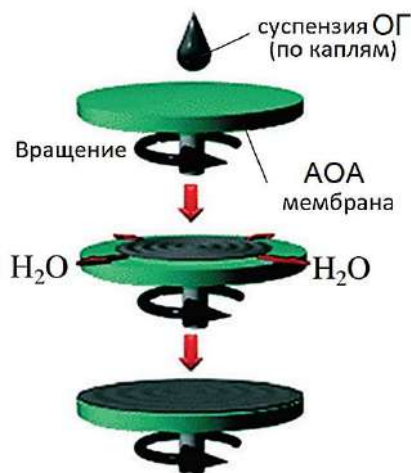
Рисунок 67. Формирование тонкого селективного слоя методом нанесения на вращающуюся подложку.
