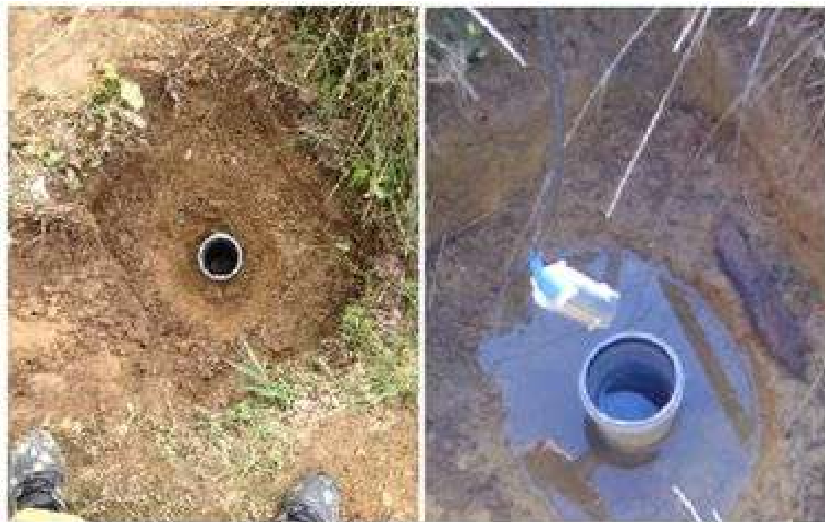
Рисунок 2.7. Скважина для установки гидрофона на полигоне Петропавловское
