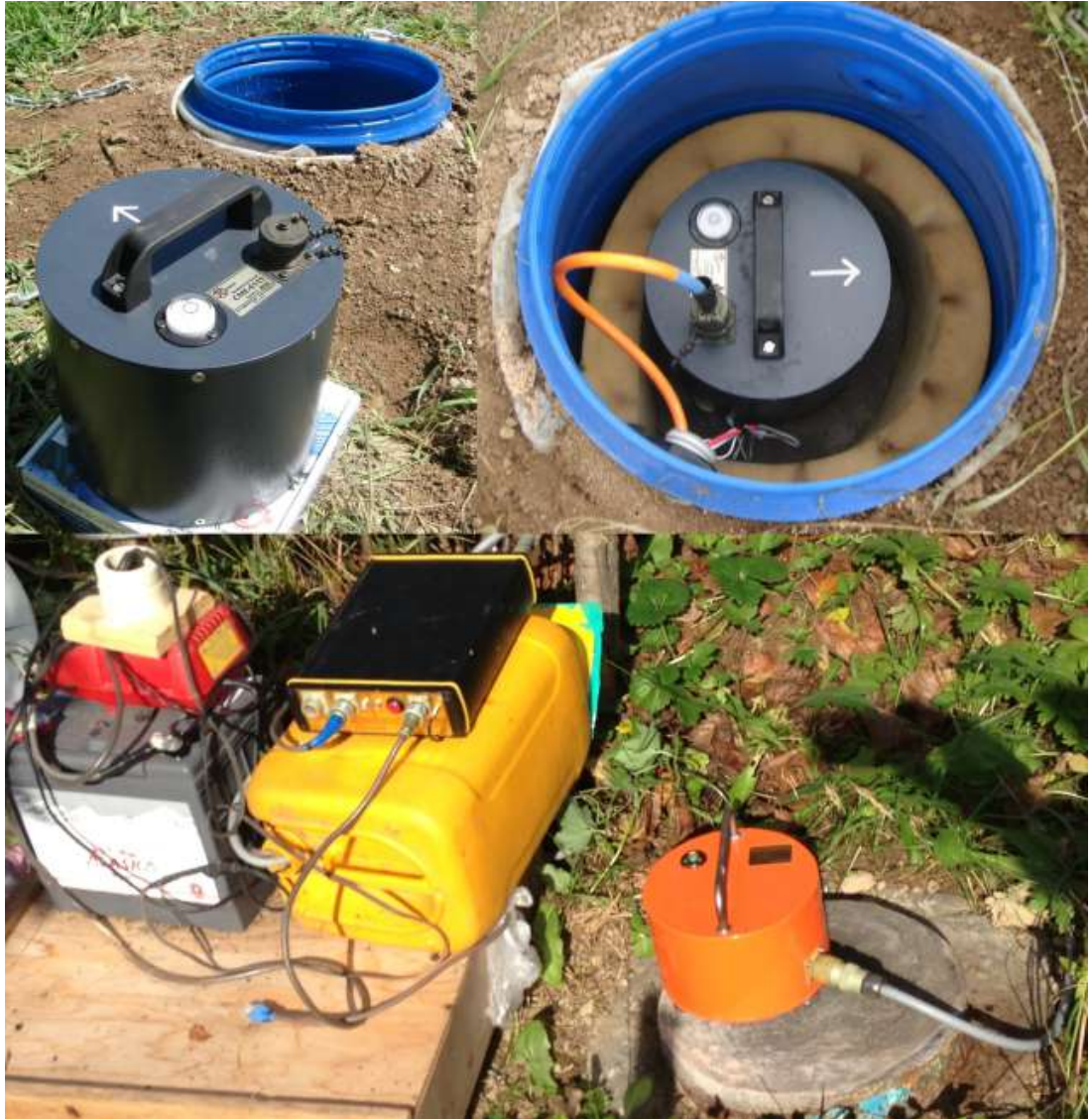
Рисунок 2.5. Установка СМЕ-6111 в сейсмокамере (сверху) и СПВ-3к на бетонном постаменте (снизу)
