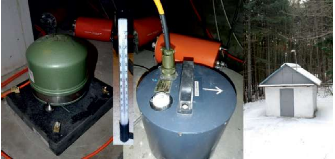
Рисунок 3.17. Внешний вид сейснопавильона сейсмической станции «Южно-Сахалинск» и размещённых в нём сейсмометров СМЕ-6111 и STS-2
