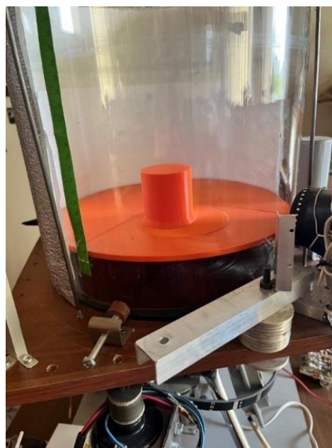
Рисунок 31. Панель А: экспериментальная установка лаборатории гидродинамики ИВП РАН, панель Б: ёмкость для жидкости со встроенным в фальшь-дно подводной неоднородностью рельефа цилиндрической формы
