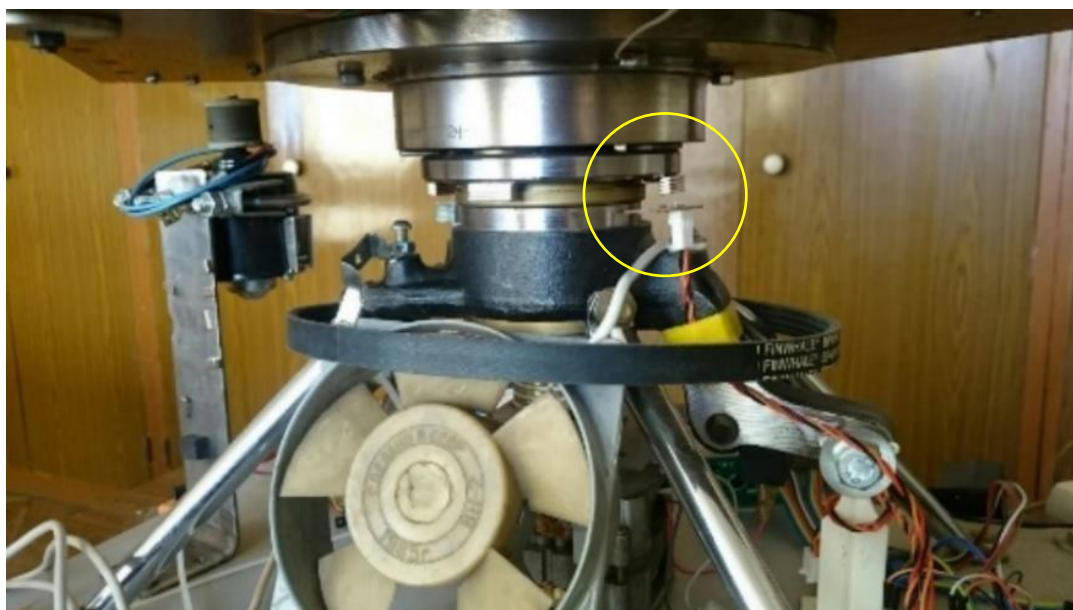
Рисунок 34. Система магнитов, расположенных под вращающейся платформой и проходящих над датчиком Холла. Связь с процессором ATmega328P реализована через красный провод
