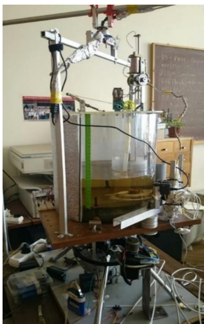
Рисунок 31. Панель А: экспериментальная установка лаборатории гидродинамики ИВП РАН, панель Б: ёмкость для жидкости со встроенным в фальшь-дно подводной неоднородностью рельефа цилиндрической формы
