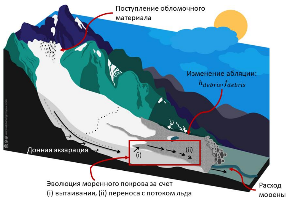
Рис. 1. Схема эволюции моренного покрова ледника, используемая в диссертации (адаптировано из Lindsey Nicholson и Anne Maussion, Atelier les Gros yeux).
