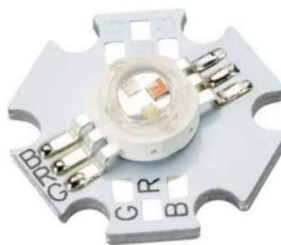
Рис. 4.2.2. Светодиод ARPL-Star-3W-EPA-RGB, аналогичный установленному на прожекторе
