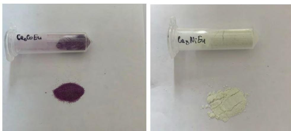
Рис. 179. Фотоизображение образцов  $\text{Ca}_8\text{CoEu}(\text{PO}_4)_7$  (слева) и  $\text{Ca}_8\text{NiEu}(\text{PO}_4)_7$  (справа).
