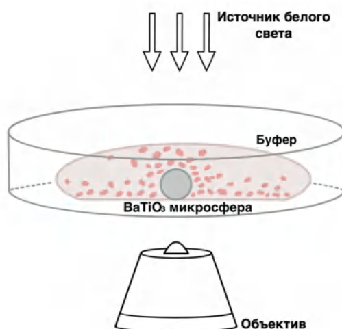
Рисунок 16. Схема эксперимента в режиме проходящего света.
