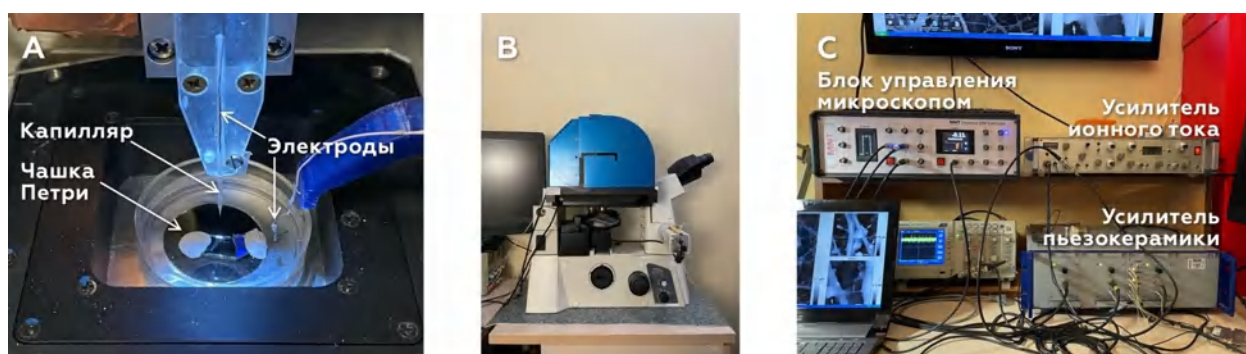
Рисунок 5. Вид рабочей области СКМ (А), установка СКМ (под синей крышкой) на базе инвертированного оптического микроскопа Nikon TI-U (В) и управляющая электроника СКМ (С)
