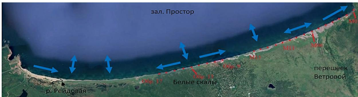
Рисунок 5. Перемещение наносов в береговой зоне зал. Простор (источник: Google Earth)
