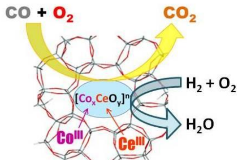
Рисунок 3.20. Активные центры кобальт-церий-модифицированного ZSM-5.
