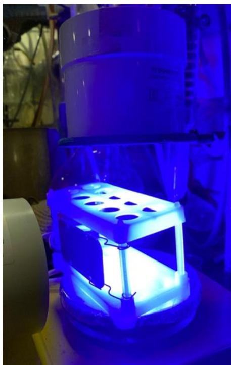
**Рис. 4.4.** Фотохимический реактор с длиной волны излучаемого света 440–460 нм.
