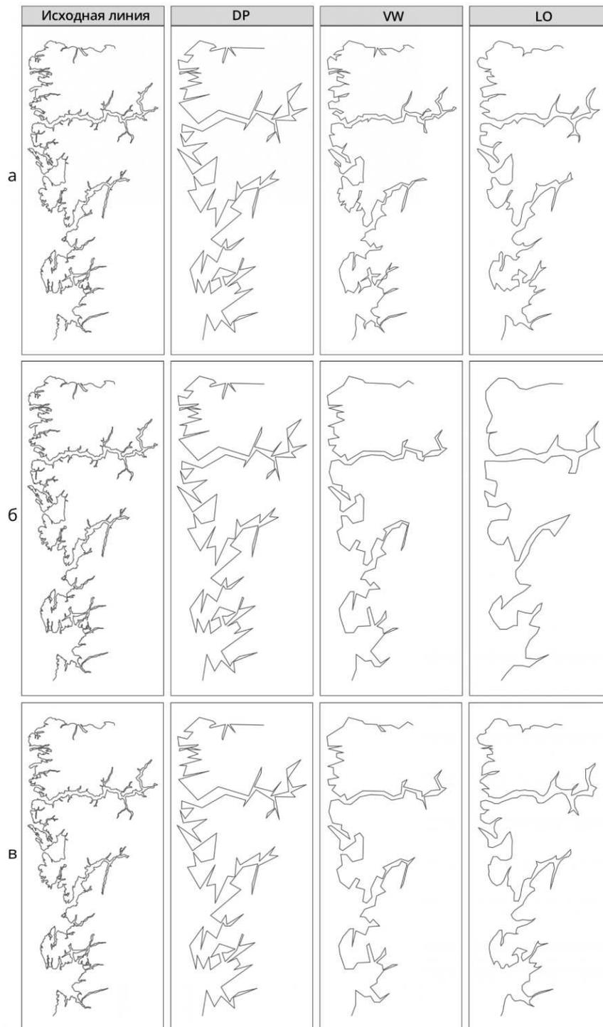
**Рисунок 3.32** – Геометрическое упрощение береговой линии Норвегии при одинаковой величине: (а) МНД, (б) сжатия количества вершин и (в) сжатия количества изгибов. DP – результат работы алгоритма Дугласа-Пейкера; VW – результат работы алгоритма Висвалингам-Уайатта; LO – результат работы алгоритма Ли-Оупеншоу
