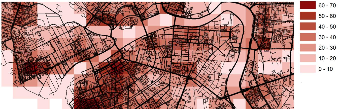
Рисунок 4.4 – Вычисление густоты дорожной сети по регулярной сетке (км/км<sup>2</sup>)
