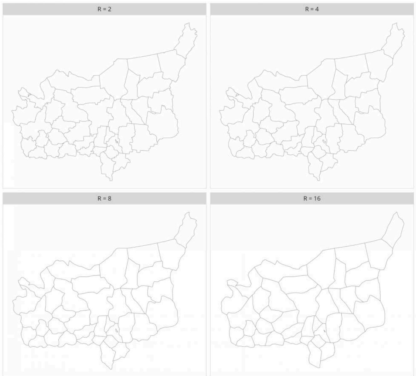
**Рисунок 2.38** – Геометрическое упрощение линий алгоритмом Ли-Оупеншоу
