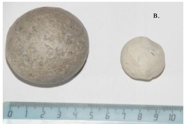
Рис. 2.16. "Оползневые ролики", образовавшиеся в основании оползневых блоков при смещении различных оползней, фото О.В. Зеркаля.
