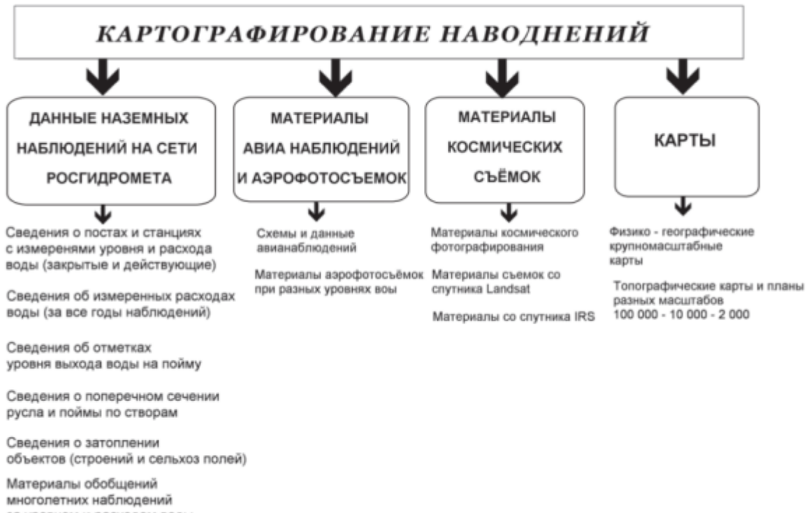
Рисунок 3.12 – Общая схема баз данных для картографирования наводнений [Методические рекомендации ... , 2009]
