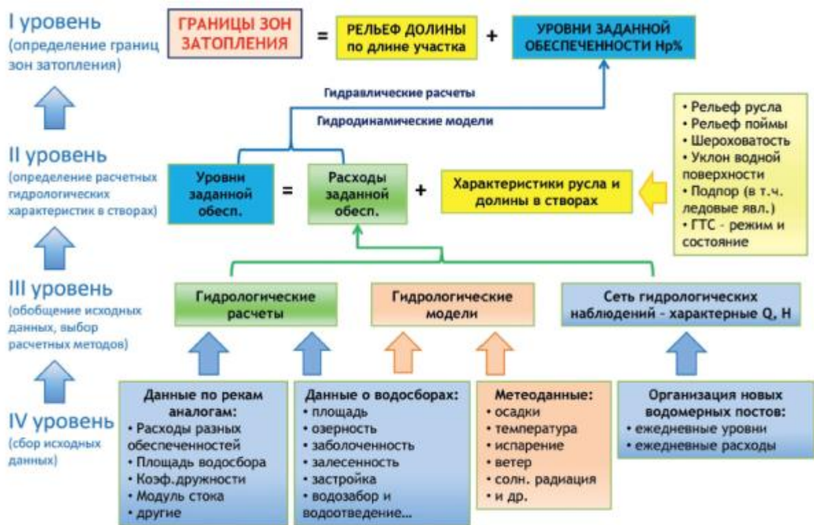
Рисунок 3.13 – Блок-схема этапов определения границ зон затопления с учетом прямых и косвенных факторов формирования наивысших уровней [Определение границ ... , 2017]
