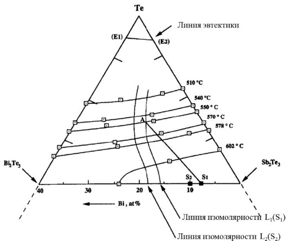
Рисунок 10. Линии изомолярности для S_1 и S_2 (состав выделяемой твердой фазы (\text{Bi}_{0,8}\text{Sb}_{0,2})\text{Te}_3 и (\text{Bi}_{0,75}\text{Sb}_{0,25})\text{Te}_3 соответственно) [37].
