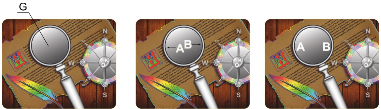
Рисунок 3.20. Характер смещения двух символов при наклоне оптического элемента.
