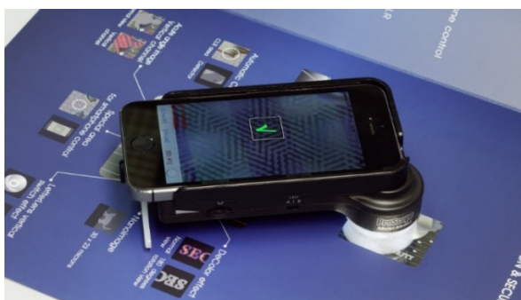
Рисунок 8.12. Регистрация изображений с помощью смартфона с использованием приставки с увеличением.
