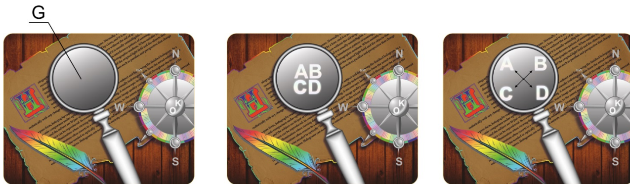
Рисунок 3.22. Характер смещения четырех символов при наклоне оптического элемента.
