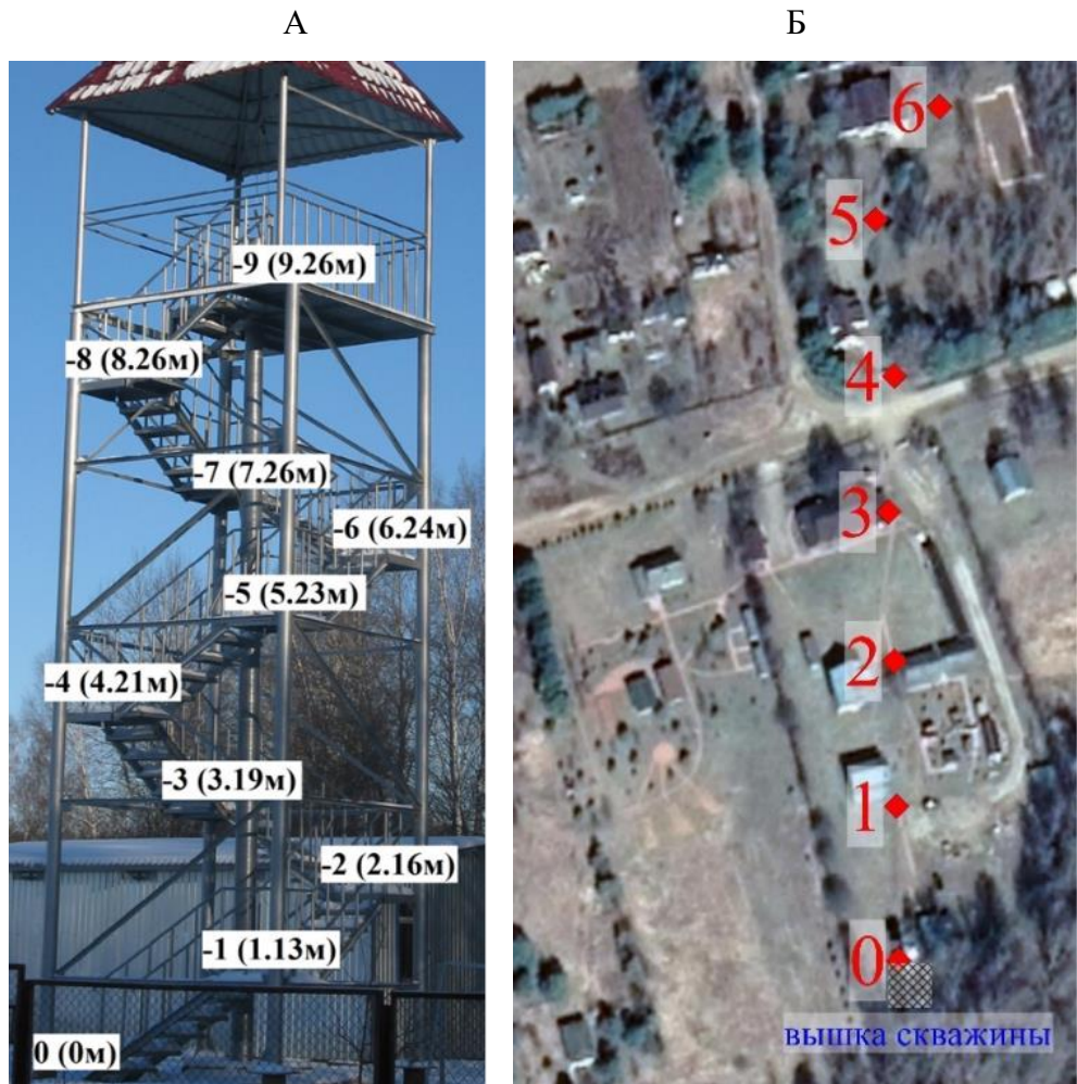
Рисунок 1.15 Схема расположения гравиметрических пунктов композитного профиля, состоящего из вертикального (А) и горизонтального (Б) сегментов на научно-учебном полигоне МГУ в дер. Александровка (Калужская область, Юхновский район) [Лыгин и др., 2017]
